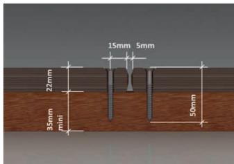
Vue en coupe du montage par vissage des lames Plydeck™
