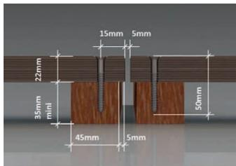
Double lambourrage et disposition des éléments en bout de lame Plydeck™
